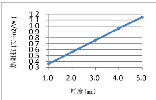
TIF™ 035AB-05S是一种高导热、液态间隙填充材料, 具有双组份及不同温度固化时间特点。它们的柔性、弹性特征使其能够用于覆盖非常不平整的表面。热量从分离器件或整个PCB传导到金属外壳或扩散板上, 因而能提高发热电子组件的效率和使用寿命。以液态方式, 提供各种厚度, 取代一般导热垫片的模切厚度, 且不同于一般硅胶片, 此系列产品固化后是干燥可触摸的, 故可被更广泛应用。
